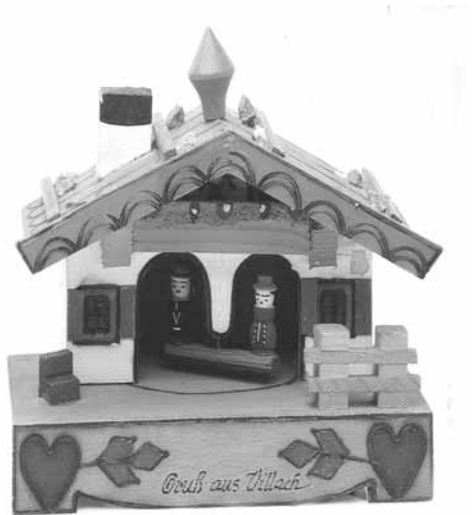
写真1 毛髪湿度計の一種 湿度により男女の人形が出入りする
