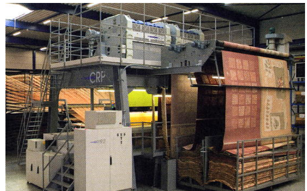
図 16 ダブルレピア織機の稼働状態
