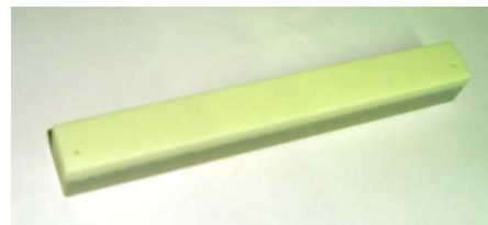
写真-1 試験体例 (20×20×180mm)
